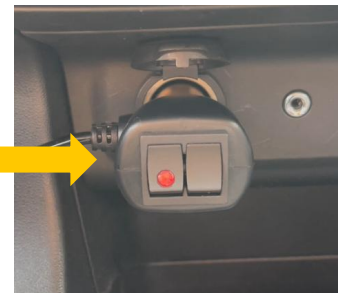
Brancher la prise allume-cigare dans le véhicule Basculer l'interrupteur pour que le voyant s'allume
