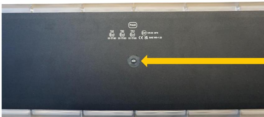
Capteur de lumière sur le dessus de la rampe pour ajuster la luminosité (jour : 100% / nuit : 50%)
