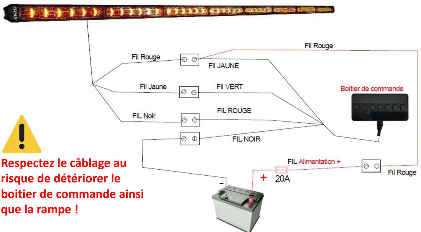
**Respectez le câblage au risque de détériorer le boîtier de commande ainsi que la rampe !**
