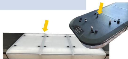
Vis pour démonter chaque module par le cabochon & accès direct aux leds pour faciliter le SAV
