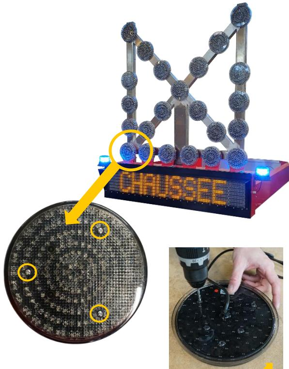
Percer à travers les 3 trous préformés avec un foret de 4,5mm, par la face arrière. Puis visser.
